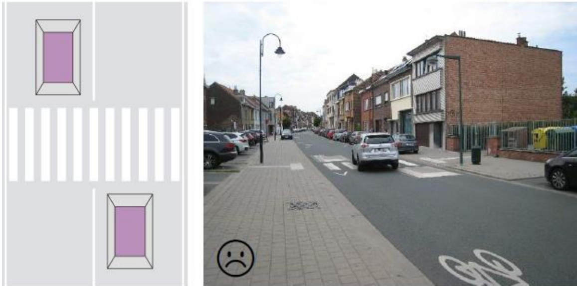
Figuur 6: Gevaar voor onaangepast gedrag bij rijbaankussens met zigzagdoorgang zonder fysieke scheiding [OCW 2020_1]
