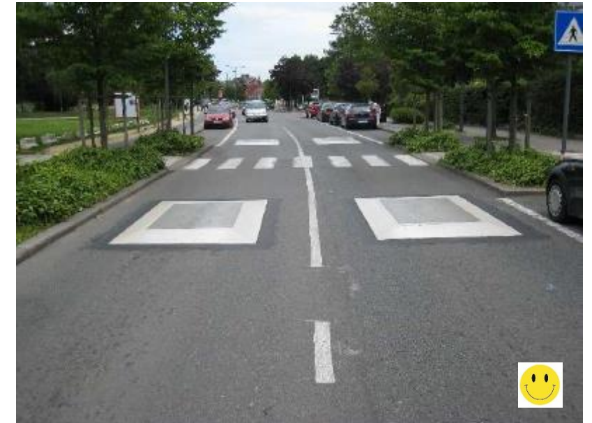
Figuur 7: Naast elkaar geplaatste rijbaankussens bij een oversteekplaats voor voetgangers op een rijbaan die tussen 6 en 7,2 m breed is [OCW 2020_1]
